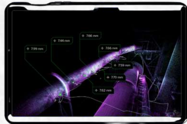
Flyability - Elios 3 UT / Ultrasonido: Análisis de Espesores
